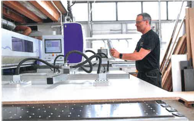
Beladung einer CNC-Bearbeitungsmaschine mit dem VacuMaster Wood Comfort
